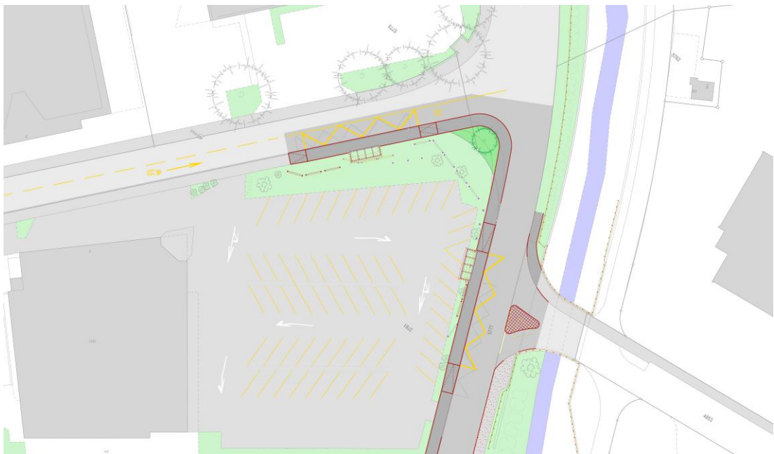
Abbildung 3: Anpassung Bushaltestellen Brandbachstrasse
